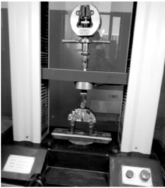
图 2 半圆弯拉试验
