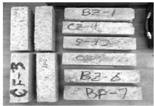
图3 部分水泥稳定碎石试件
