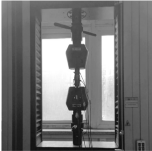
图 3 轴向拉拔试验装置 Fig. 3 Axial tensile test device
