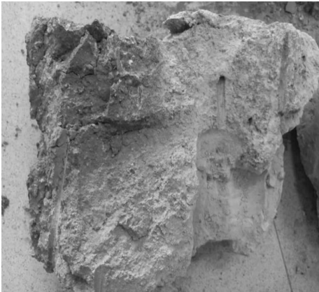
图10 电动化学加固后的土样
