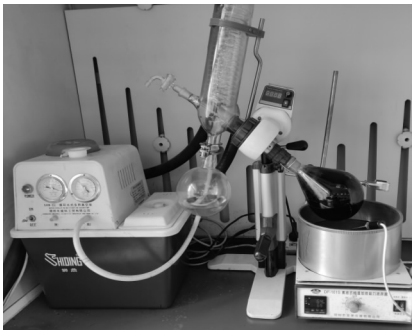
图 1 旋转蒸发器
