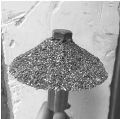
(c)先装拔出法破坏体
