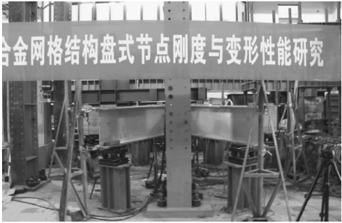
图 4 PS1 加载装置图
