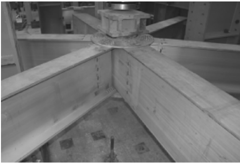
图 2 铝合金盘式节点试件 Fig. 2 Specimens of TEMCOR joints
