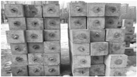
图 7 自由端钢筋 Fig. 7 Free end reinforcement
