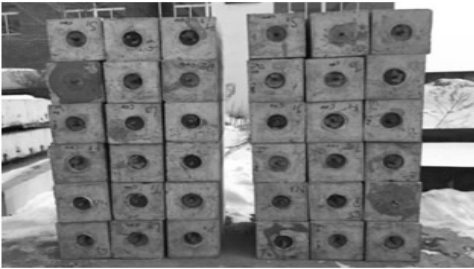
图 6 加载端钢筋 Fig. 6 Loading end reinforcement
