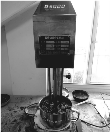
图1 SBS 改性生物沥青的制备
