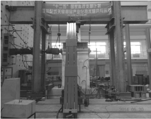
图3 试验加载装置图
