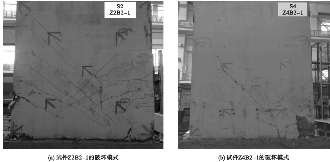
图 6 试件破坏模式
