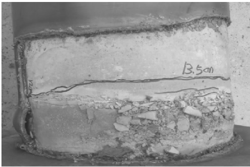
(b) 桥墩底部内填混凝土破坏情况
