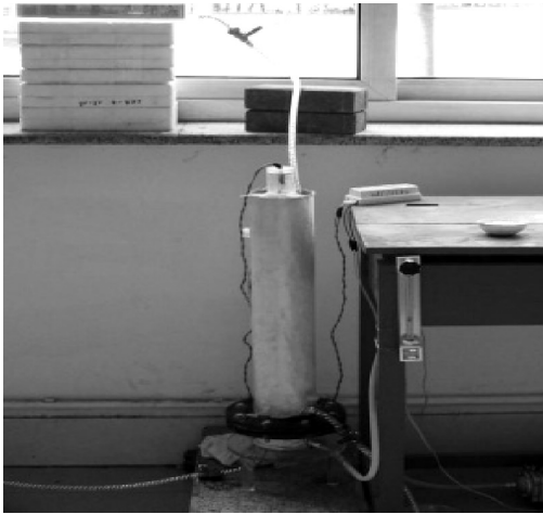
图 2 紫外光催化氧化装置
