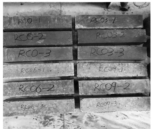
图1 养护7 d的再生混凝土试块
